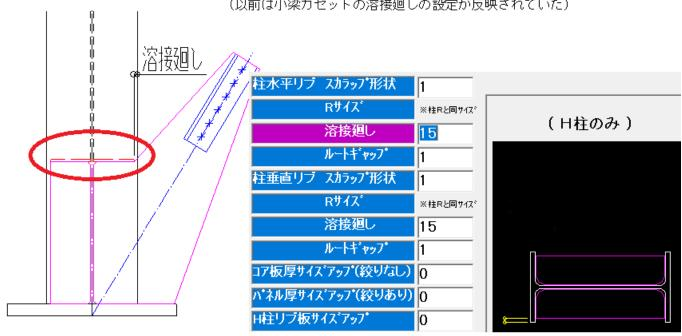
・裏側に入る縦リブの溶接廻しを「柱詳細-初期設定-柱垂直リブ」の溶接廻しを見るようにしました。
